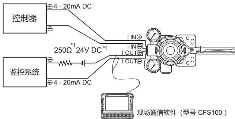
图 2. 带开度传送功能的定位器 (型号 AVP301 )
