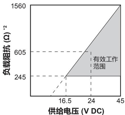
图 3. 开度变送供给电压和负载阻抗特性
